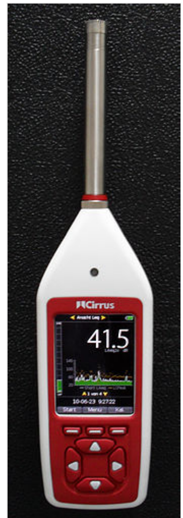
Moderner integrierender Schallpegelmesser nach IEC 61672 mit Einzelmessbereich (120 dB) und Echtzeit-Oktavbandfiltern
